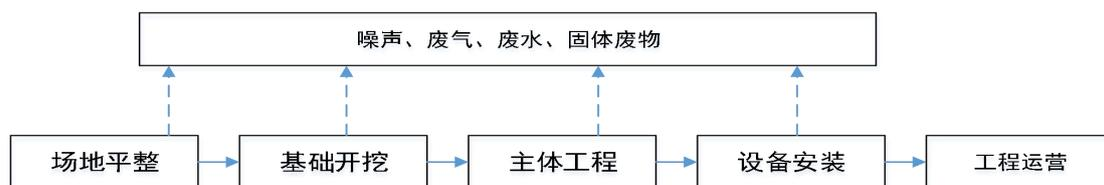
图2.2-1 污水处理站施工流程图
